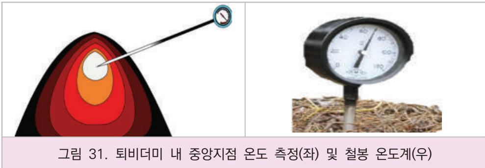
그림 31. 퇴비더미 내 중앙지점 온도 측정(좌) 및 철봉 온도계(우)
